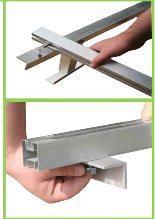
Stecken Sie das Gewinde der **M10er Schrauben** durch die zuvor gebohrten Löcher in den **Aufständerungsdreiecken (A)**. Schrauben Sie mit geeignetem Drehmoment die M10er Muttern auf und verbinden so die **Montageprofile (B)** fest mit den **Aufständerungsdreiecken (A)**. Vor dem endgültigen Festziehen lassen die **Profile (B)** sich in der Waagerechten verschieben und so mittig ausrichten.
